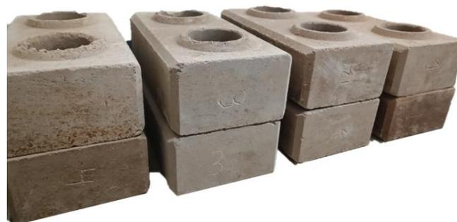
Los ensayos iniciales de secado y dureza indicaron que las primeras dos formulaciones (I y II), con altos contenidos de lodo y arena exclusivamente gruesa, no alcanzaron un desempeño adecuado en términos de consistencia ni resistencia preliminar. En contraste, las formulaciones III y IV, que incorporaron mezclas de arenas de diferentes granulometrías y un menor porcentaje de lodo (30% y 20%, respectivamente), mostraron un comportamiento favorable durante el secado y una dureza inicial superior.
